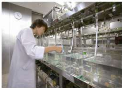
流水式曝露試験装置 メダカへの化学物質曝露試験
