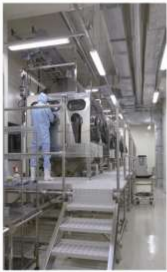
環境ナノ粒子吸入曝露装置 マウスへの環境ナノ粒子吸入実験
