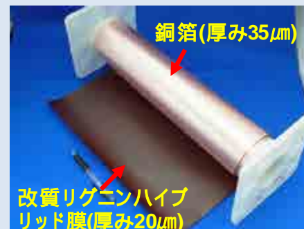
銅箔積層型改質リグニンハイブリッド膜
