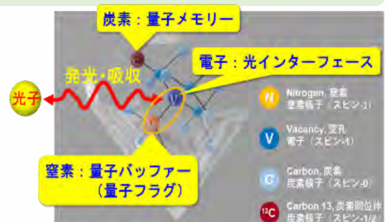
図1 ダイヤモンドNV中心に内蔵された量子システム
