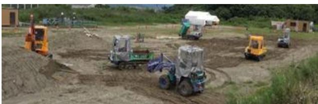
九州大学フィールドでの協働土砂運搬動作検証(6台の無人建機による)
