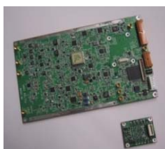
コグニティブ無線機用ハードウェアプラットフォーム、左: 高周波部、中: FPGA信号処理部、右: CPU信号処理部
