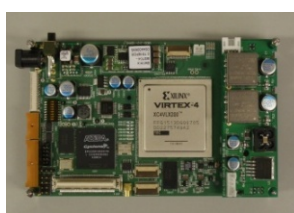
コグニティブ無線機用ハードウェアプラットフォーム、左: 高周波部、中: FPGA信号処理部、右: CPU信号処理部
