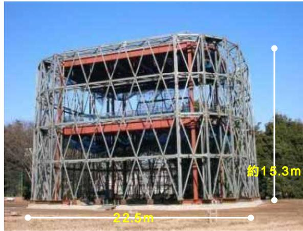
屋上加振機(アクティブマスダンパー)を設置し、制振性能確認実験を実施
