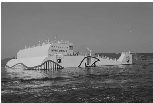
沖合浮体式波力装置「マイティーホエール」
