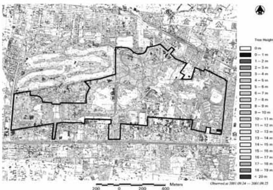
図-1 IKONOS 画像とレーザープロファイラーによる樹木域の樹高抽出
