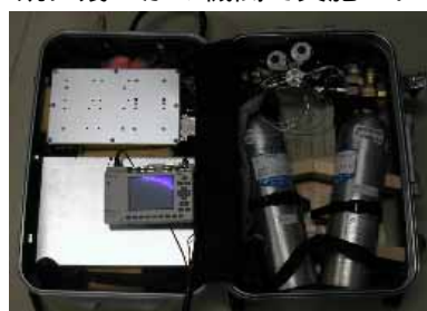
図 1 小型航空機用 CO 2 計測システム。右が標準ガス。左上が二酸化炭素計、左下部が電源・大気サンプリグ系
