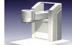
レーザー血栓溶解装置試験機 血管内に挿入したファイバーを血栓部位まで進め、フラッシュレーザーを血管内で照射する。血栓の吸収スペクトルと動脈壁の吸収スペクトル差を利用して血栓を溶解するものである。
