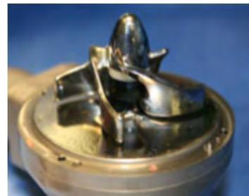
三次元形状のポンプ回転翼が血液の高流量を実現。血液ポンプにはミスズ工業の精密加工技術を応用。
