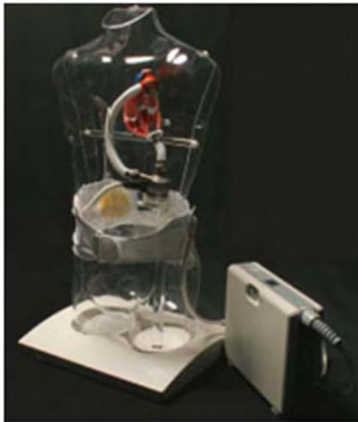
体内で補助心臓として機能する血液ポンプと、体外からこれを制御するコントローラで構成。
