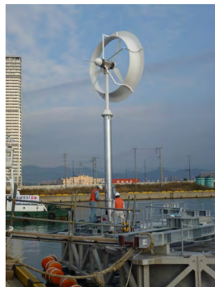
3kW レンズ風車 (ロータ径 2.5m、レンズ径 3.4m)
