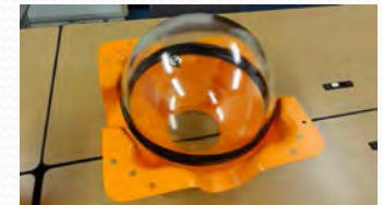
ガラス球を浮力体兼 圧力容器として使用
