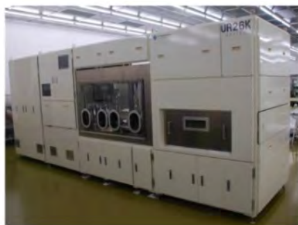
量産型MOCVD装置(8インチ径×6枚)
