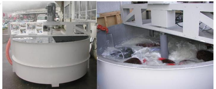
図2 高速攪拌塩漬装置と海藻の塩漬の様子
