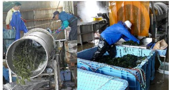
図3 従来の塩漬工程(食塩混合作業、塩漬作業)
