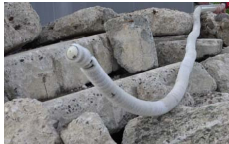
空気浮上を用いた瓦礫内移動
