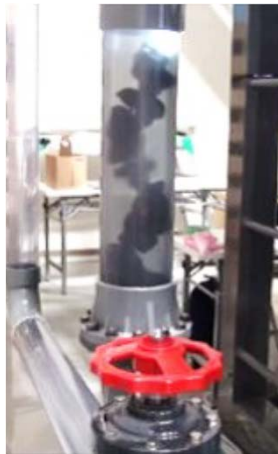
配管内部を螺旋捻転運動で移動する
