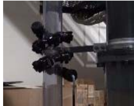
配管外周に巻き付いて移動。フランジや分岐部分も走破可能
