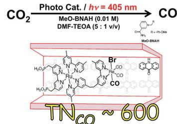
光捕集と二酸化炭素の還元系を組合せた複合触媒の模式図。
