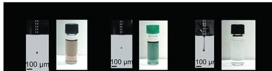
カーボンナノチューブ(金属・半導体)およびイオンゲル(絶縁体)のインクジェット印刷
