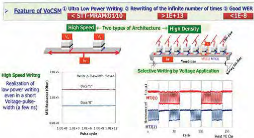
図 11 VoCSM メモリアーキテクチャコンセプトの基本動作の実証
