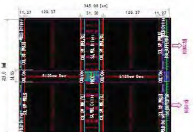
図 14 商用 CMOS28nm で設計した 1Mb VoCSM メモリ回路 (ガラスマスクレイアウト)
