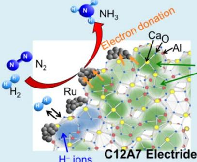
セメント材料の構成物質  $12\text{CaO} \cdot 7\text{Al}_2\text{O}_3$  (C12A7) を用いて、**従来の触媒より10倍の活性を持つ高性能アンモニア合成触媒の開発に成功！**
