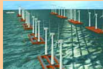
洋上風力発電プラットフォーム
