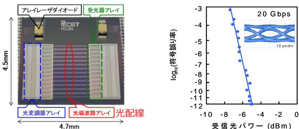
図 2. シリコン基板上に光電子集積回路を実現し、チャンネル当たり 20Gbps、30Tbps/cm<sup>2</sup> の伝送帯域密度を実証
