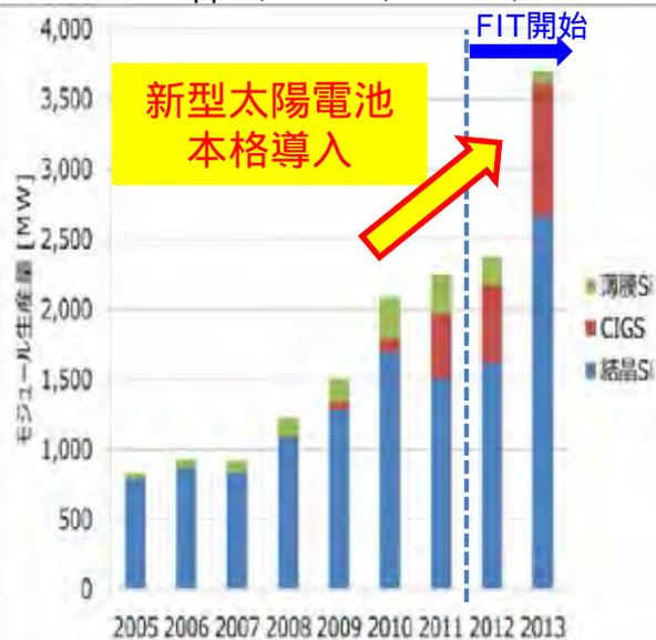
図 国内太陽電池モジュール生産量推移
