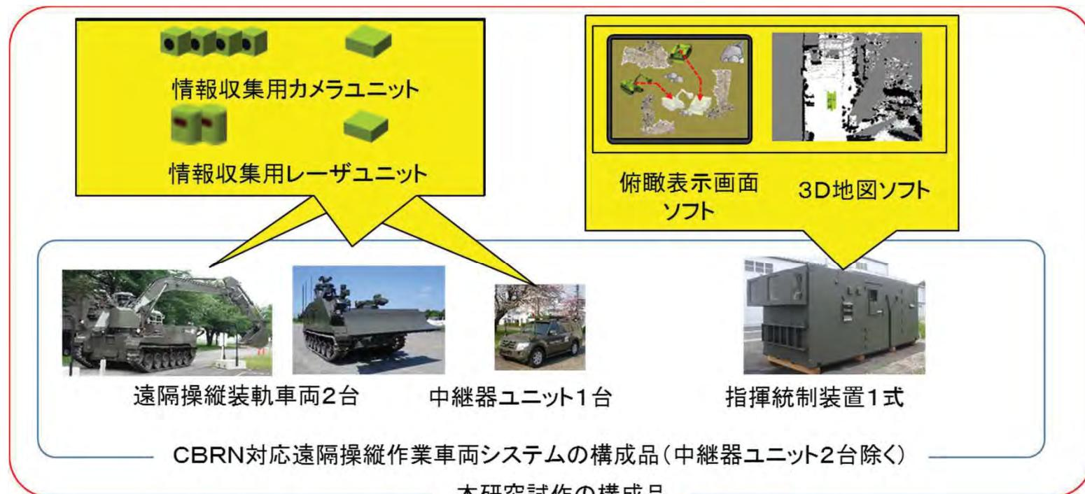
現在のCBRN対応遠隔操縦作業車両システムに追加する本研究試作の構成品(黄色部)
