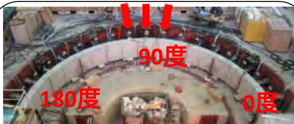
(外径9.7m、覆工厚さ30cm) 実物大のトンネル覆工载荷実験
