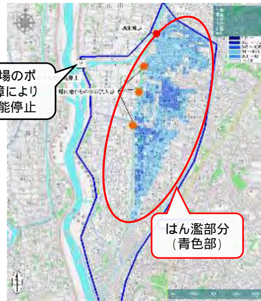
ポンプ故障によるはん濫シミュレーションの例
