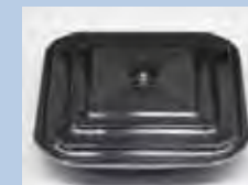
作成に成功した 大口径、四角形のシリコン結晶の塊
