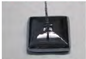
超高品質角型単結晶Si 高品質かつロスが少ないシリコン単結晶の作成に世界で初めて成功
