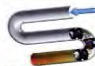
インテリジェント・ピグ (検査ピグ)
