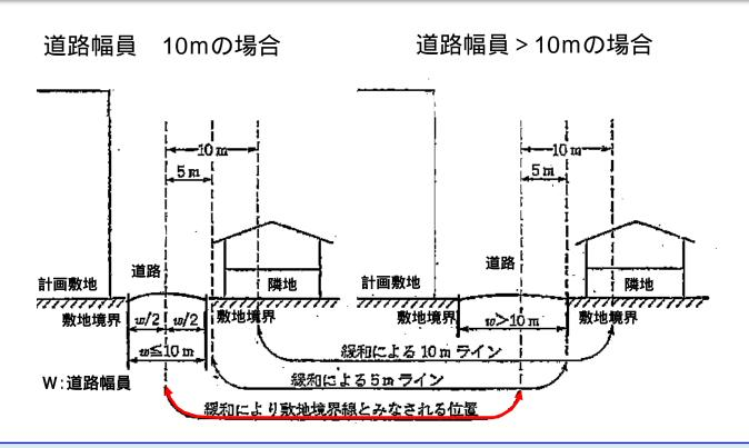
結果として、日影時間の規制対象となるラインは道路幅員の1/2(幅員が10m以上の場合は幅員から5mを差し引いた距離)だけ通常に比べ外側に緩和される。
