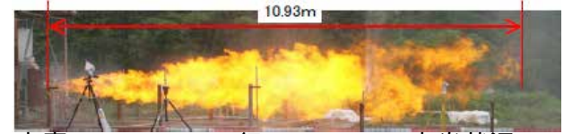
水素（60MPa、口径4mm）での火炎状況 （出典：三菱重工業(株)の実験）
