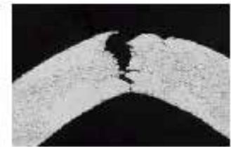
水素脆化による割れ(もろい) （出典：昭和電線ホールディングス(株)）
