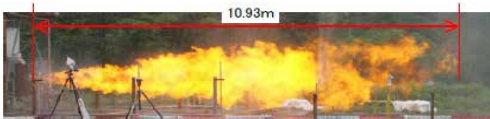
水素（60 MPa、口径4.0mm）での火炎状況 （出典：三菱重工業(株)の実験） NEDO委託研究として実施
