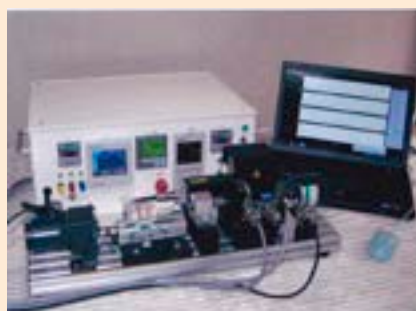
歯科大学の学生の研究用に設計・試作した虫歯治療用ドリルの強度試験装置
