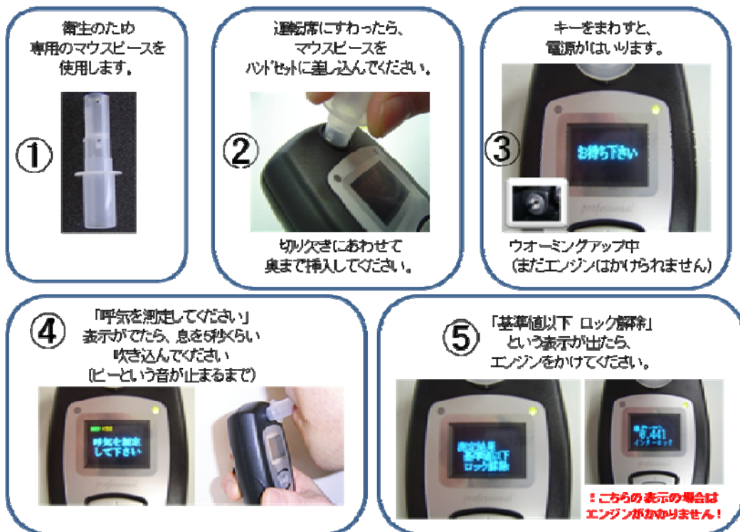
図5.6 アルコール・インターロック装置の使い方
