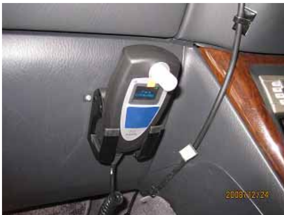
図 5.11 ハンドセット取り付け例
