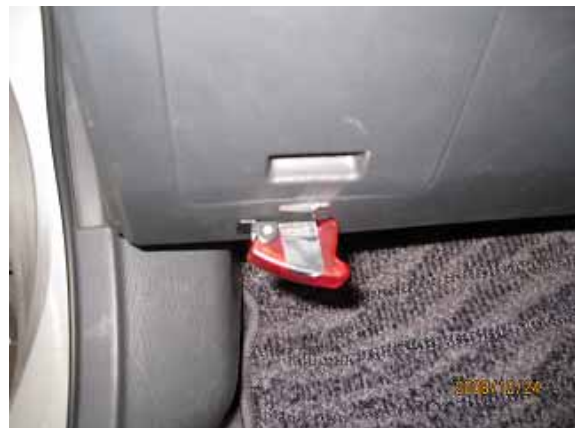
図 5.12 緊急時バイパススイッチ取り付け例
