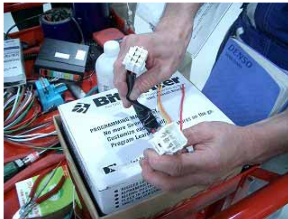
図 5.10 コントローラに取り付けに使用したリモコンエンジンスターター用ハーネス
