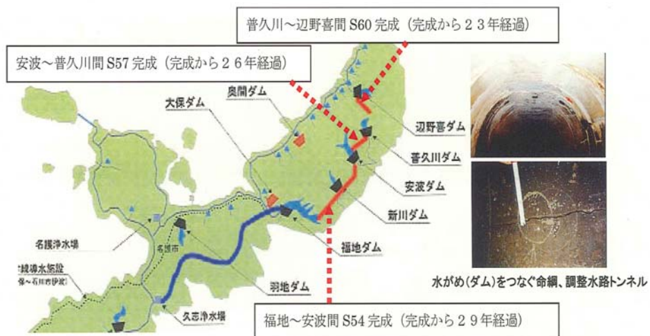
(表 46) 老朽化する導水路トンネル
