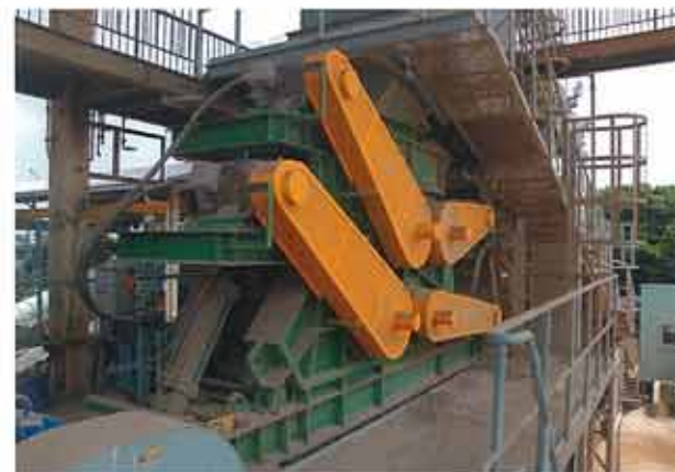
多軸式混合機 (特許出願中)
