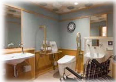
バリアフリー仕様トイレ （客室）
