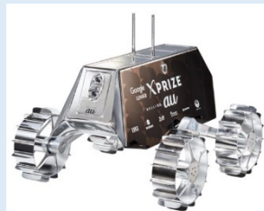
HAKUTO HPより抜粋 月面を走行するローバー フライトモデル
