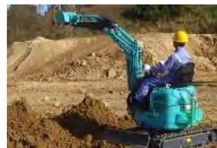
アームを油圧ショベルへ取り付け た状態で各種評価試験を実施
