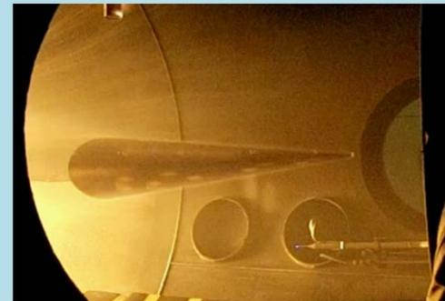
HIESTを用いた自由飛行試験
