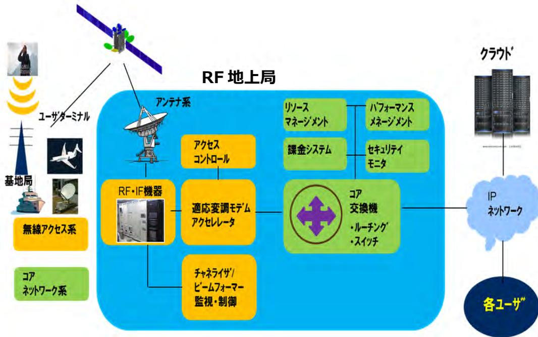
図 20 RF 地上局機能系統例
