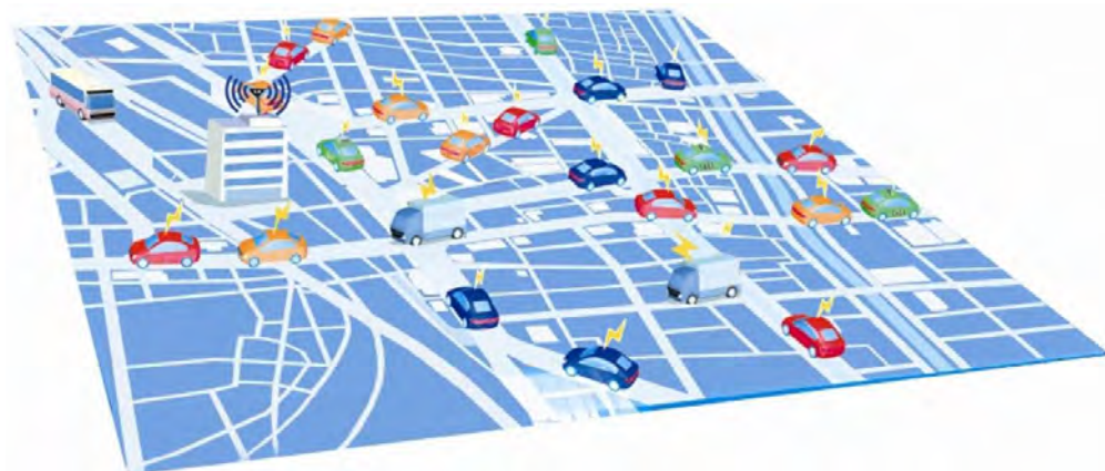
それぞれの車がセンサーになる交通観測 (プローブカー)
