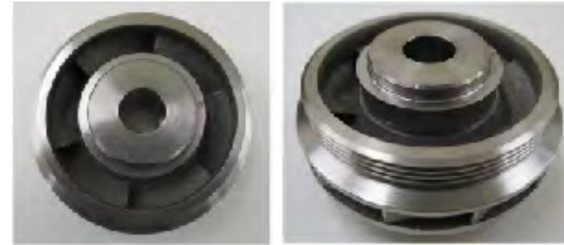
積層造形（3Dプリンタ）によるポンプのインペラ
