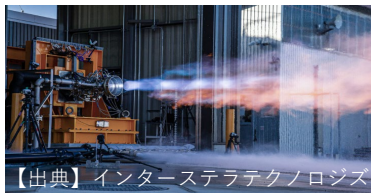
【出典】 インターステラテクノロジズ インターステラテクノロジズ社は液化バ イオメタンを燃料としたエンジンの 燃焼試験に成功。
