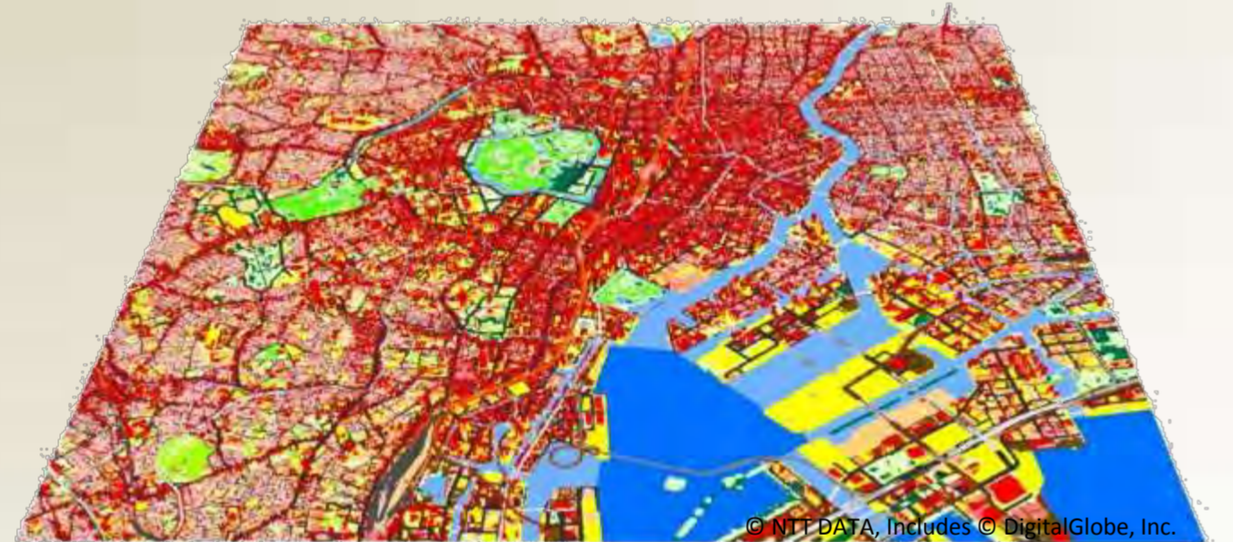
図1 通信分野での利用事例 (無線電波の伝搬特性を把握、設備計画に活用)
