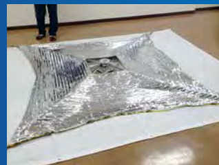
膜展開式軌道離脱装置(左:DOM1500 右:DOM2500 ※数字は膜の1辺の長さ)
