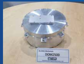
膜展開式軌道離脱装置(左:DOM1500 右:DOM2500 ※数字は膜の1辺の長さ)
