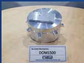
膜展開式軌道離脱装置(左:DOM1500 右:DOM2500 ※数字は膜の1辺の長さ)
