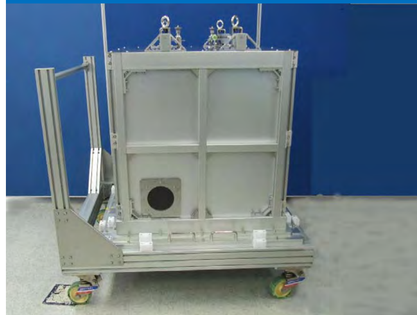
衛星ドーリ(N2-gas)
