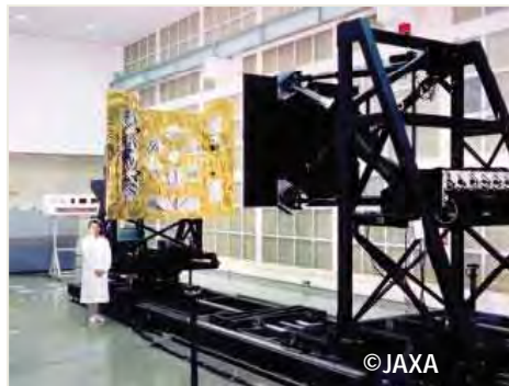
ランデブ・ドッキング試験設備 (モーション・シミュレータ)
