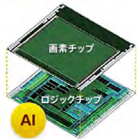
インテリジェントビジョンセンサーの積層構造イメージ
