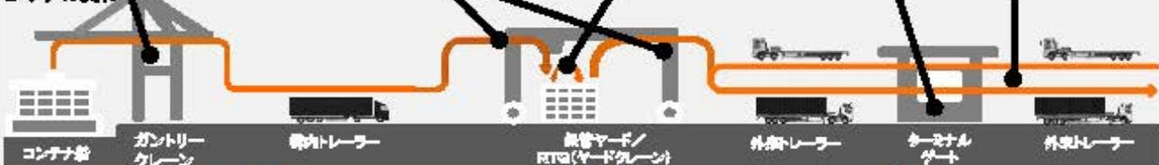
コンテナ船    ガントリークレーン    海外トレーラー    積卸ヤード/RTG(ヤードクレーン)    海外トレーラー    ターミナルゲート    海外トレーラー
