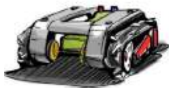
AIで作物と雑草を識別し、手作業や除草剤に頼らないロボットによる機械除草
