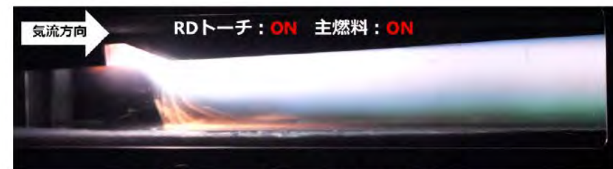
RDトーチによる着火・保炎試験の様子
